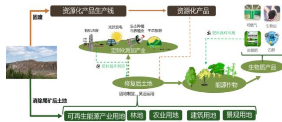
图 2. 矿山生态修复技术路线
